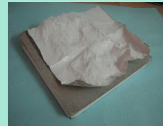
Tấm dán PVC bong rộp khỏi bề mặt giấy.
